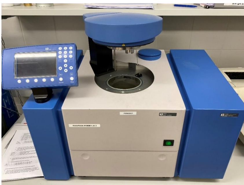
Joonis 45. Seade IKA-Calorimeter C5000 kütteväärtuse määramiseks
