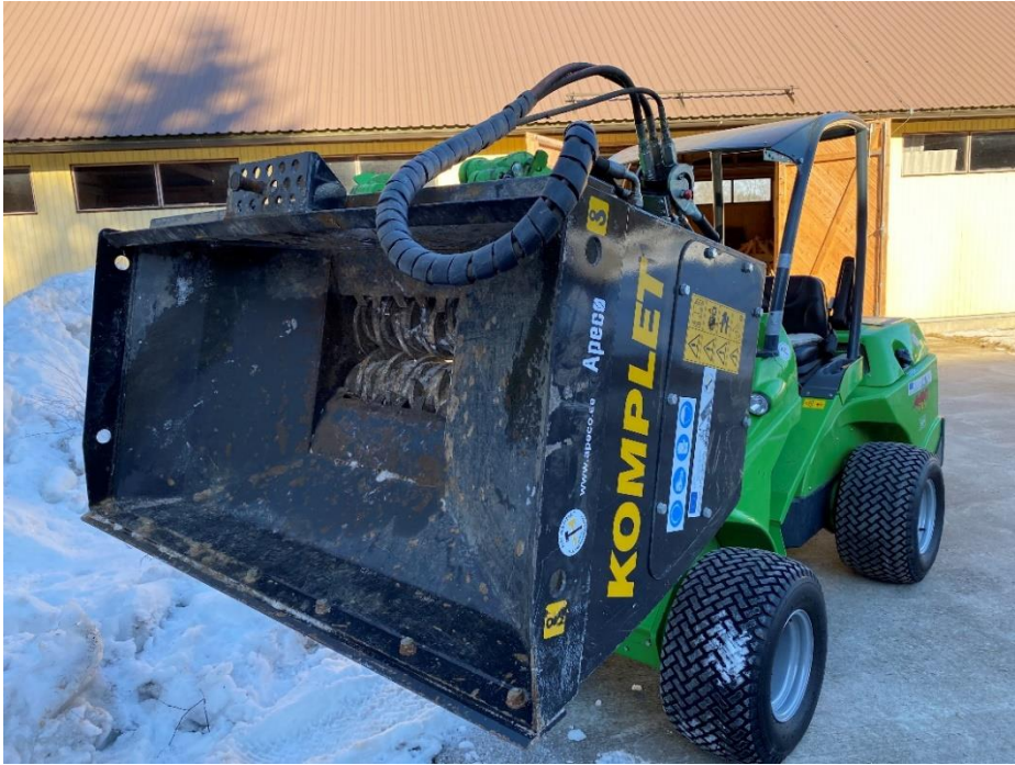
Joonis 12. Kopplaadur Avant 745 koos mobiilse purusti Komplet Italia SLR RCB 6000
