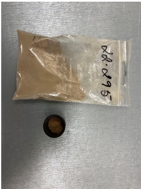
Joonis 44. Anum kütteväärtuse määramiseks koos prooviga
