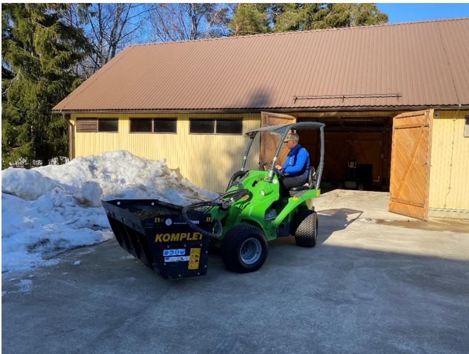
Joonis 13. Lõputöö autor kopplaadurit koos purustiga opereerimas Järgnevalt viisin läbi esimese purustamistsükli.
