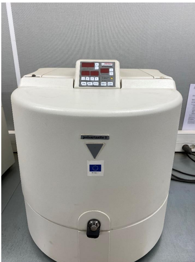
Joonis 42. Seade proovi jahvatamiseks
