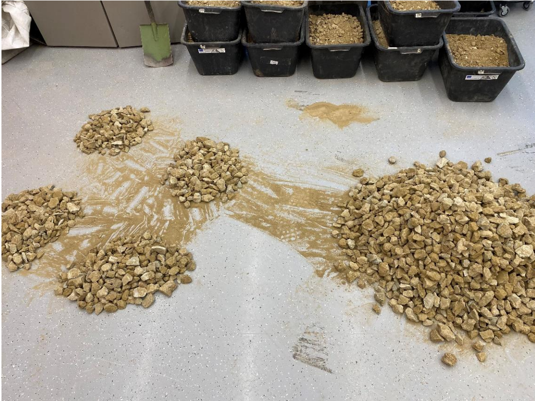
Joonis 22. Proovide kvarteerimine sobivaks koguseks.
