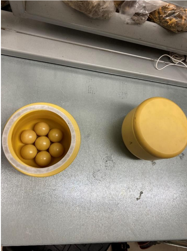
Joonis 41. Metallkuulid anumasse proovi jahvatamiseks
