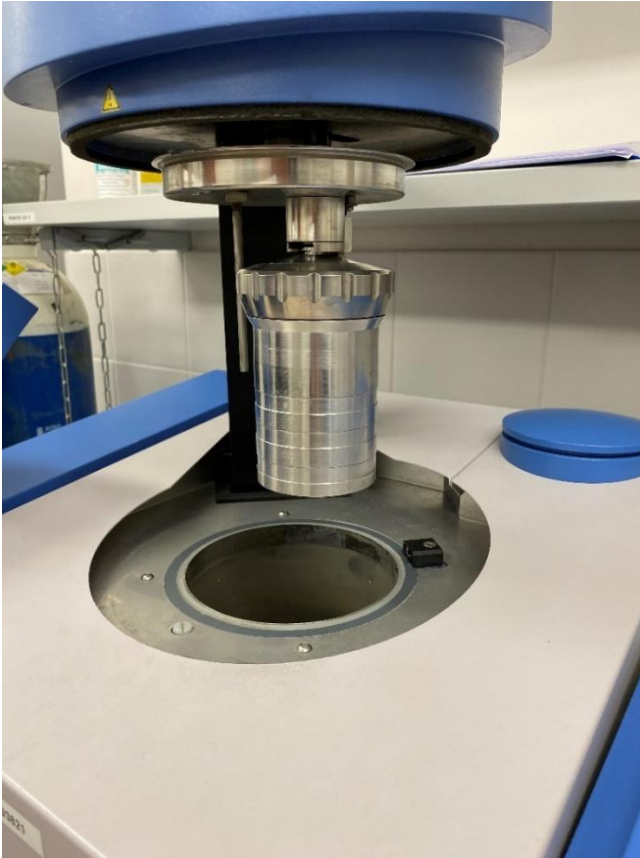
Joonis 46. Silindriline anum, kuhu asetatakse proov kütteväärtuse määramiseks
