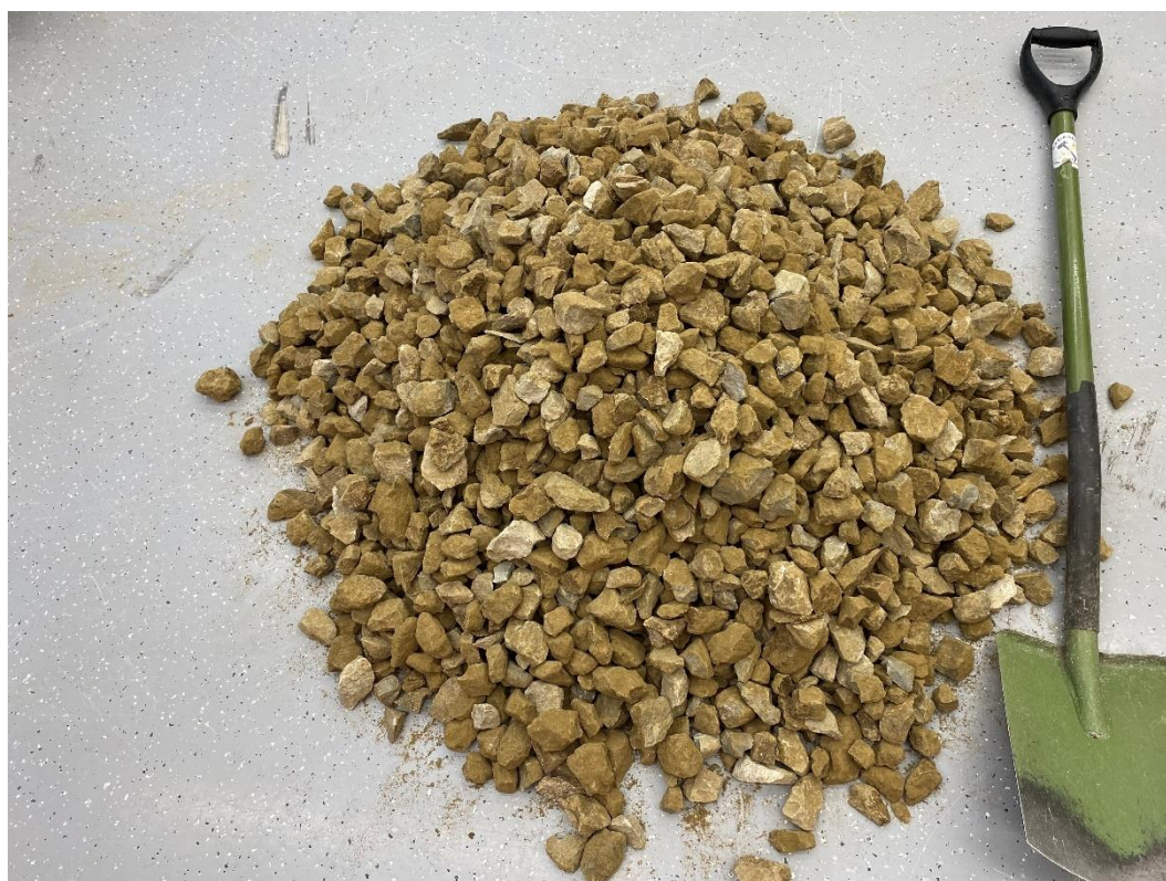
Joonis 20. Tükisuurusega 32-63 mm sõelumisel saadud kuhila
