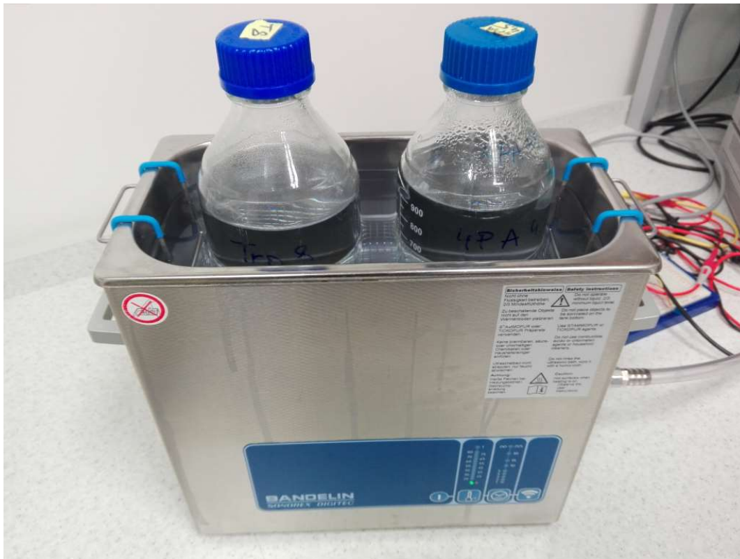
Joonis 11. Lahuste degaseerimine ultrahelivanni abil.
