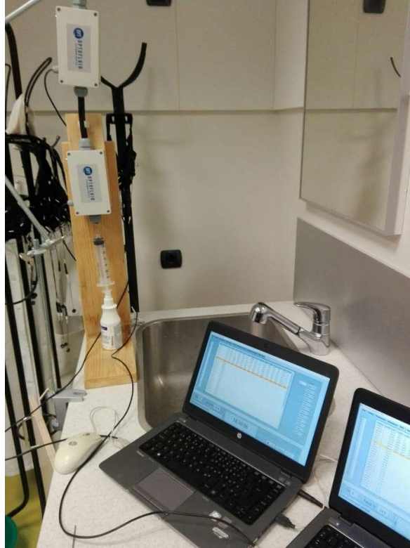
Joonis 10. Kalibreerimisestend koos paigaldatud seadmetega.
