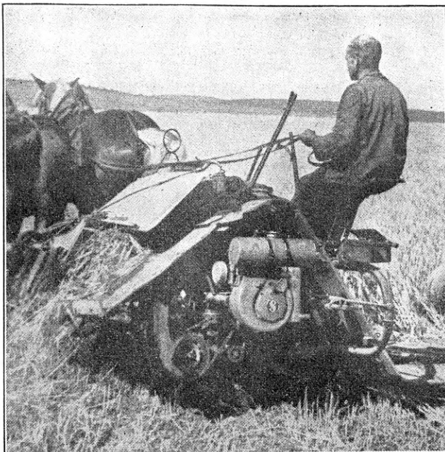
Joon. 3. Abimootor teeb ära lõikusetöö, kuna hobustele jääb ainult masina vedamine.
