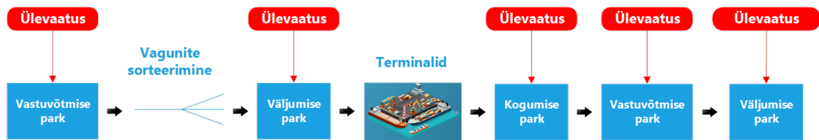
Joonis 1.14 Tehnohoolduse skeem Luzhskaya jaamas enne tehnoloogia muutmist Allikas: autori koostatud
