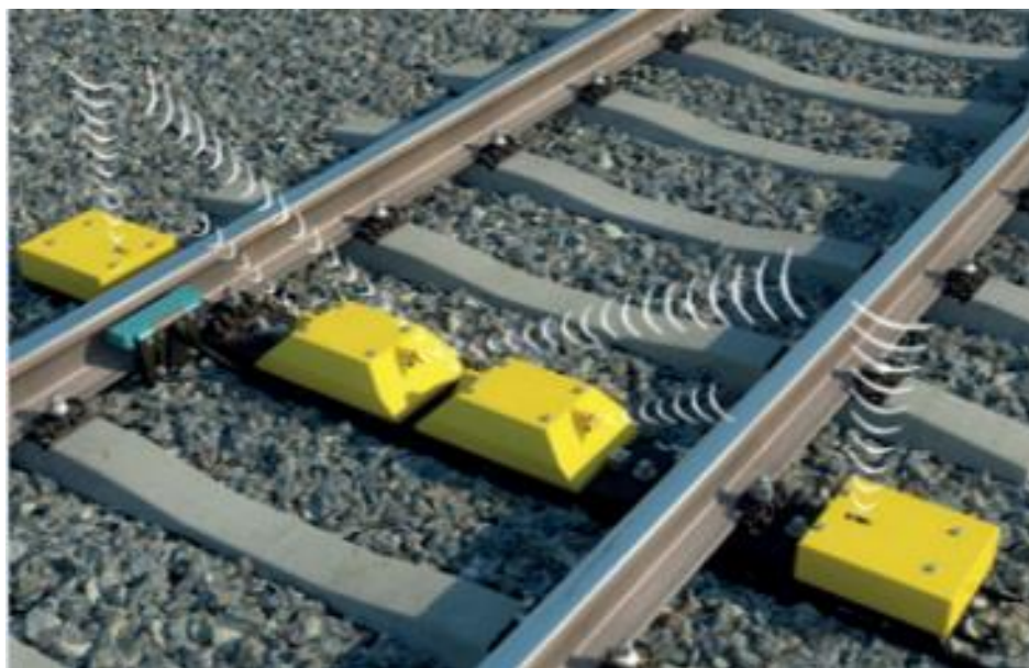
Joonis 2.7 Veeremi teljelaagrite ülekuumenemise avastamise seade Allikas: [44]
