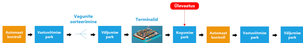
Joonis 1.15 Tehnohoolduse skeem Luzhskaya jaamas peale tehnoloogia muutmist Allikas: autori koostatud
