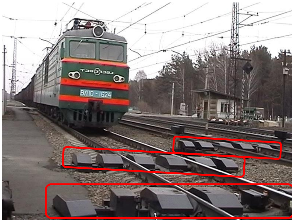
Joonis 1.10 Diagnostikasüsteem koos infrastruktuurile paigaldatud anduritega Novosibirski läheduses
