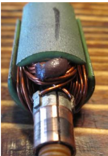
Joonis 3.1.2 Airsofti mootori rootor [35]
