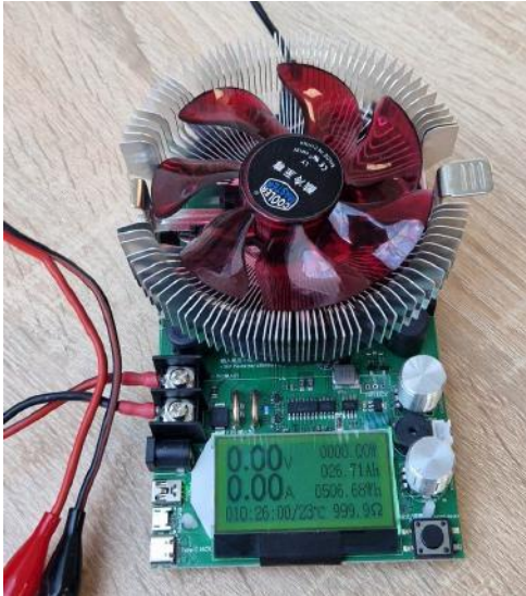
Joonis 4.1.10 Testiseade integreeritud amper- ja voltmeetriga
