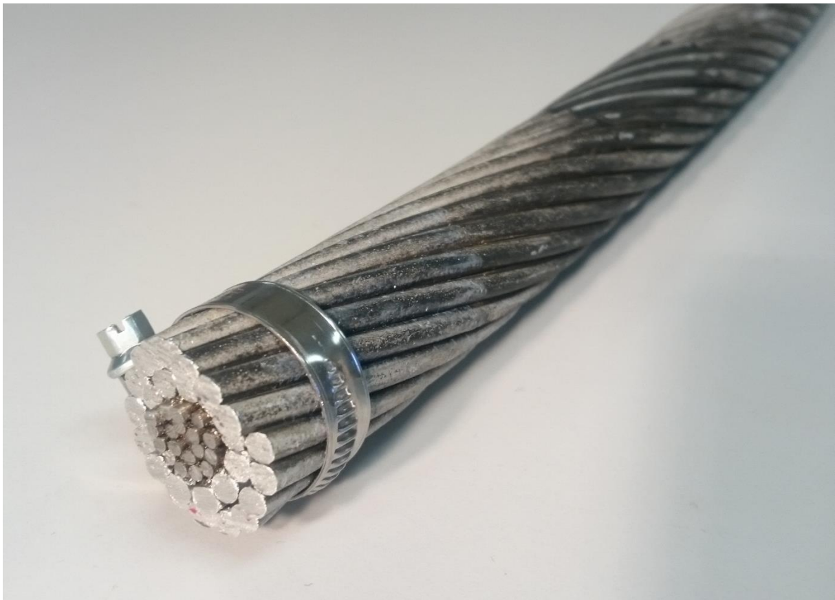
Joonis 4.2 Vananenud õhuliinijuhe AC-400
