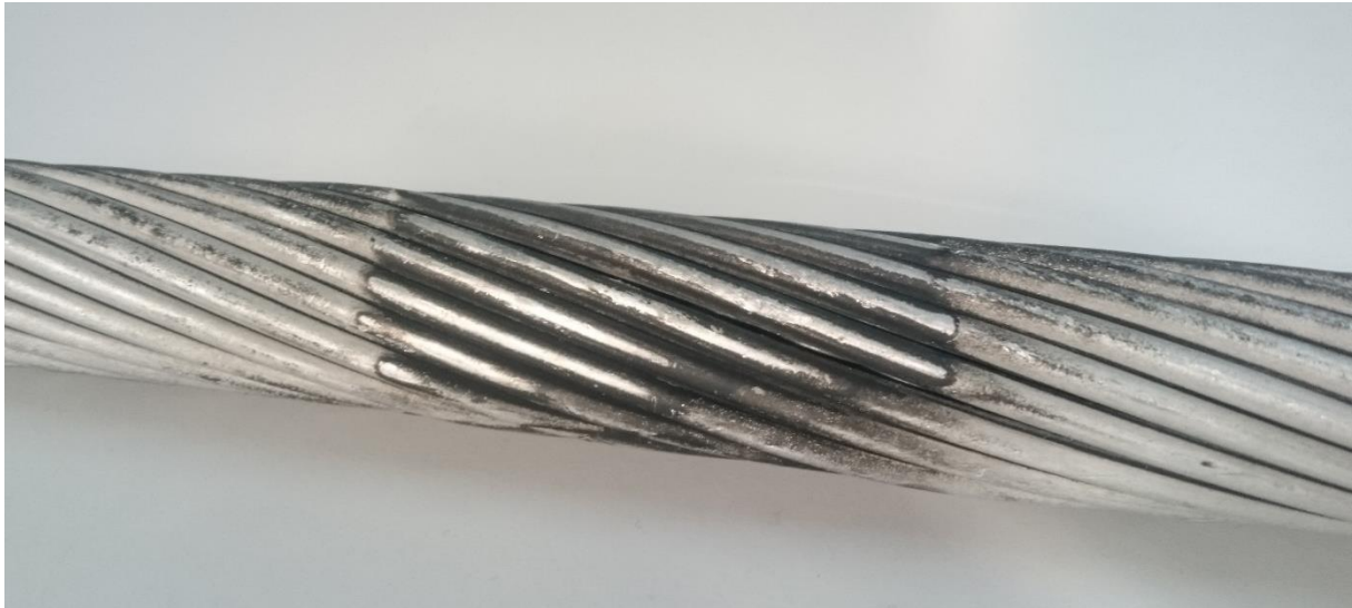
Joonis 4.3 Vananenud õhuliinijuhe AC-400 vibratsioonisummuti kinnitusklemialune ala
