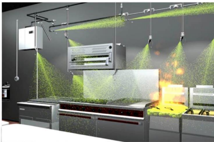
Joonis 2.5 Kohtkustutussüsteemi põhimõte köögis [23]
