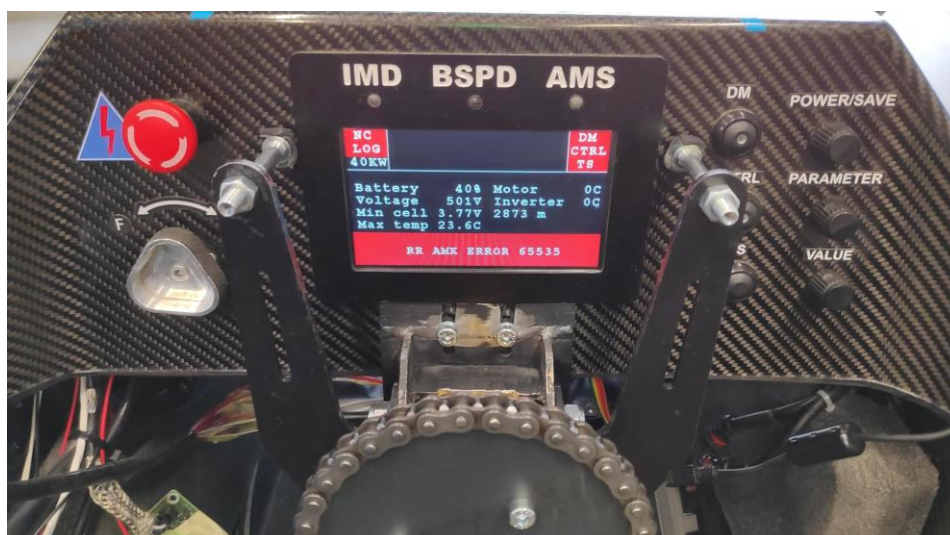
Joonis 1.3 FES18 armatuurlaud(hammasratta ja keti asemel oli varem rool)
