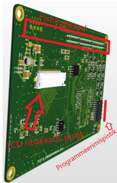
Joonis 2.17 Trükkplaadi pistikute paigutus
