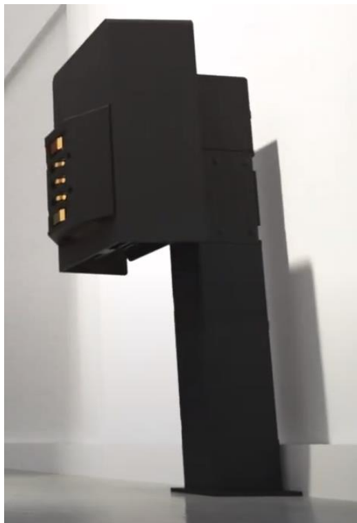
Joonis 3.1 Toyota OAE120CB laadimisdokk [38]
