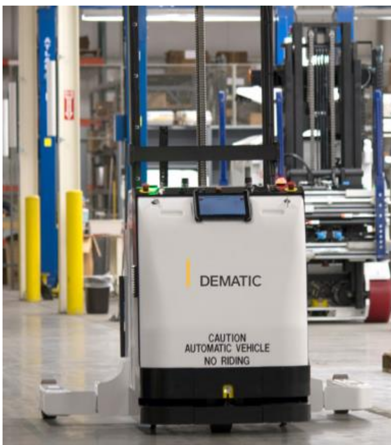
Joonis 2.3 Robottõstuk Dematic Compact Straddle Fork [15]
