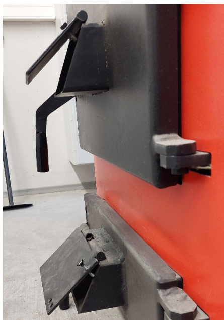
Joonis 3.17 Liigõhu reguleerimine halupuukatlal LUK-35
