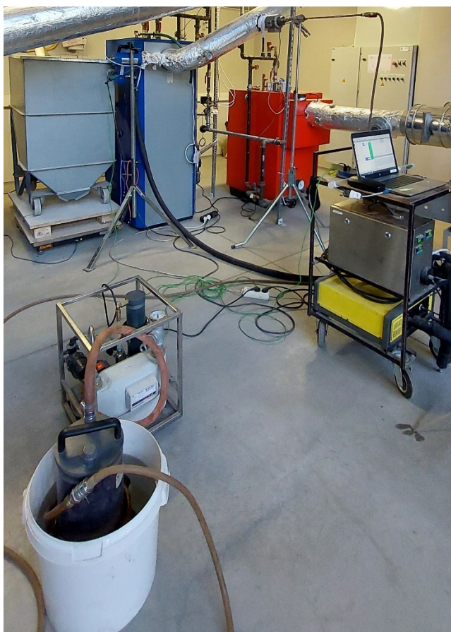
Joonis 2.1.4 Õhuheitmete mõõtmised Paul Gothe Johnas II kaskaadimpaktori (vasakul) ja Gaset DX-4000 FTIR spektromeetriga (paremal) Tallinna Tehnikaülikooli Energiatehnoloogia Instituudi katsehallis
