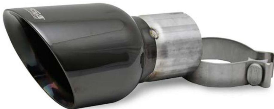
Joonis 1.7 Summutitoru ots ehk väljalasesüsteemi kõige tagumine osa [3]
