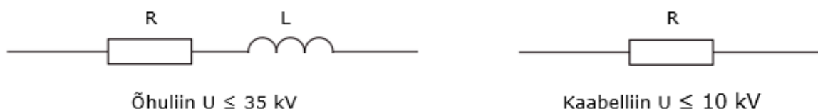
Joonis 3.2 Õhuliini ja kaabelliini koondparameetritega aseskeemid [20]
