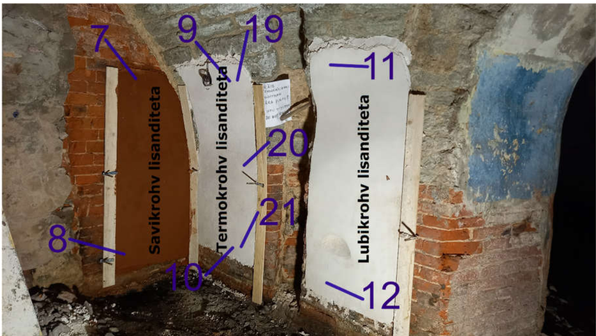
Joonis 22. Soolaproovide asukohad 2 kuud peale krohvimist, sein 2
