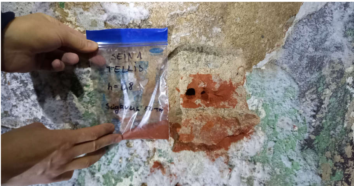
Joonis 18. Puurauk kust, võeti soolaproov ja suletav kott proovi säilitamiseks
