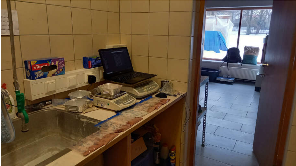
Joonis 14. Enne krohvide paigaldamist seintest võetud soolaproovide kaalumine
