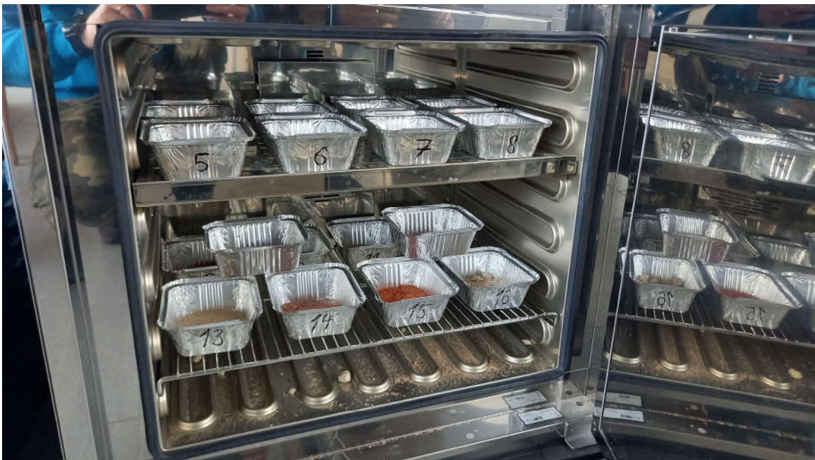
Joonis 15. Soolaproovide kuivatamine 105°C juures 48h
