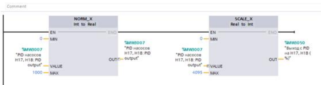
Рисунок 16. Линеаризация входного сигнала ПИД-регулятора в проценты [2]
