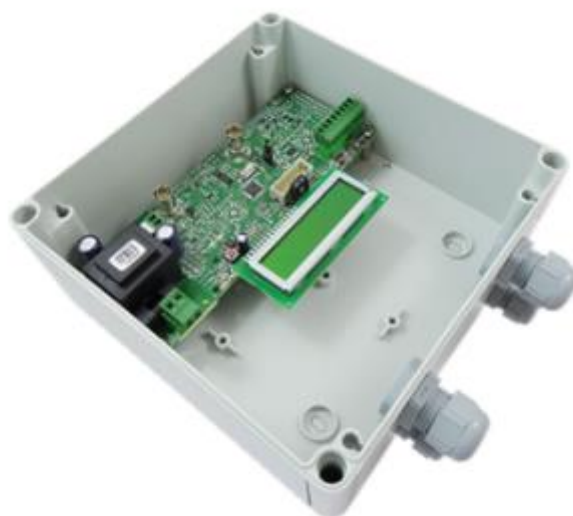
Joonis 2.7 RFID lugeja tootjalt GAO RFID [20]
