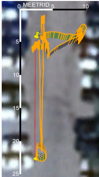
Joonis 5.11 a) Here+ RTK GPS liikumistrajektor b) Hex Here 2 GPS liikumistrajektor
