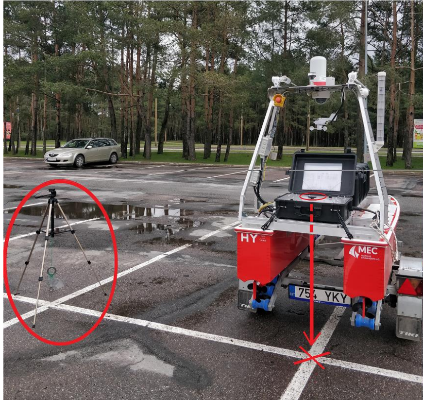
Joonis 5.2 RTK baasjaama antenni paiknemine parkimiskohtade ristumispunktis statiivil ning NYMO musta kasti sees oleva GPS paiknemine parkimiskohtade ristumispunktis enne katsetusi
