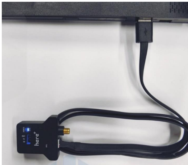
Joonis 4.2 Baasjaam ühendatud arvutiga püsivara uuendamiseks
