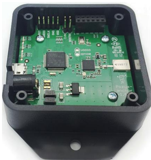
Joonis 2.6 Pozyx-i poolt pakutava UWB süsteemi majakas [19]
