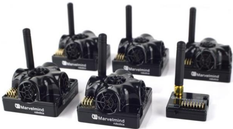
Joonis 2.9 Marvelmind-i poolt pakutav ultraheli positsioneerimissüsteem nelja majakaga ja ühe modemiga [22]
