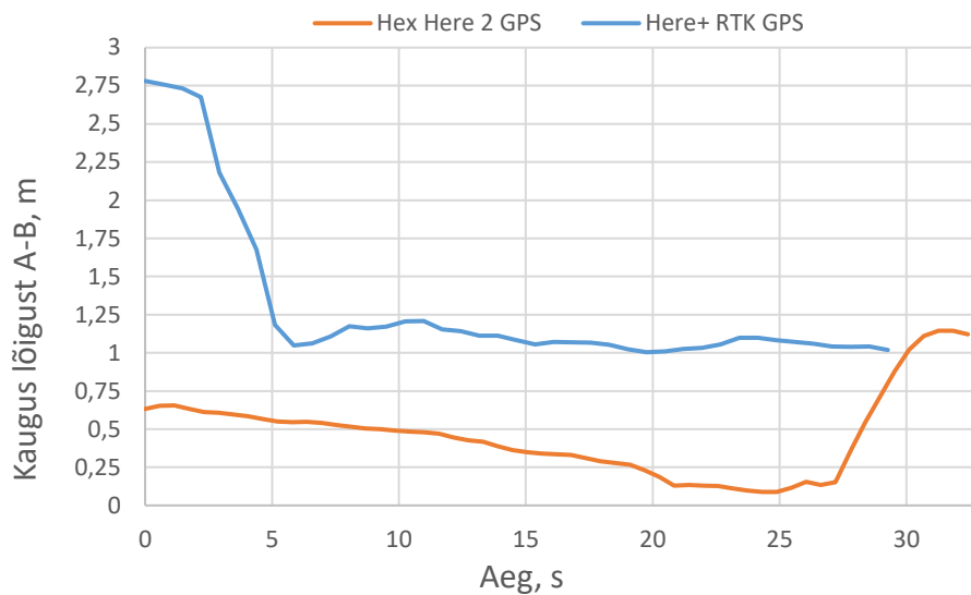
Joonis 5.9 Süsteemide positsioonandmete kaugus õigest trajektoorist liikudes A-st B-sse
