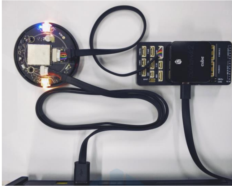
Joonis 4.1 Liikuvjaam (vasakul) ning Pixhawk kontrolleri (paremal) ühendatud arvutiga püsivara uuendamiseks [35]
