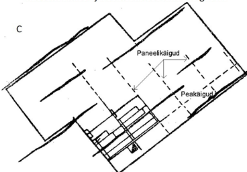
Pilt 3.30 Põlevkivikaevanduste lõigustuskeemi kohandamine vastavaks geoloogilistele oludele (C) 173
