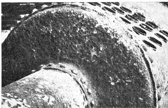
Pilt 14. Laias pindala ulatuses rügearmiliseks sööbinud lagileht püstkatla kolde juures (söövete täiskeevitamine ei ole võimalik).
