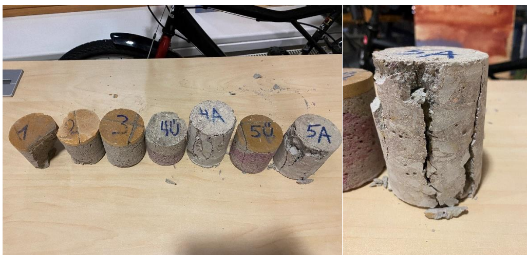
Joonis 4.7 Fotod katsetatud betoonkärnidest ja purunemispilt.
