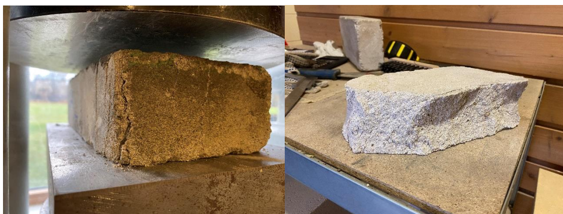
Joonis 4.8 Foto katsetatud silikaattellistest ja purunemispilt
