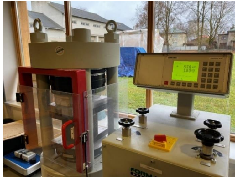
Joonis 3.11 Foto survepressist Form-Test Mega 7 ning katsetatavast silikaattellisest
