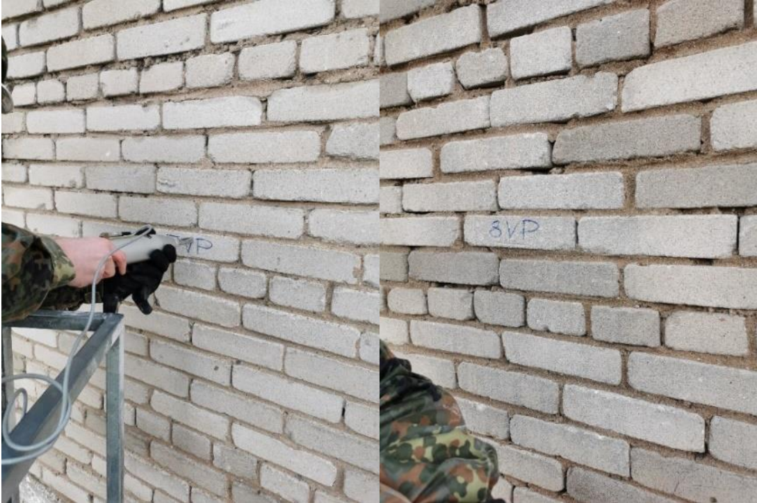
Joonis 3.14 Foto mittepurustavast pörkevasara katsest vastu Keskpuiestee 43 silikaatellismüüritise väliskoorikut (vasakul); uuritav silikaatkivi pind peale pörkevasara katset (paremal) (Fotod: M. Kiviste)
