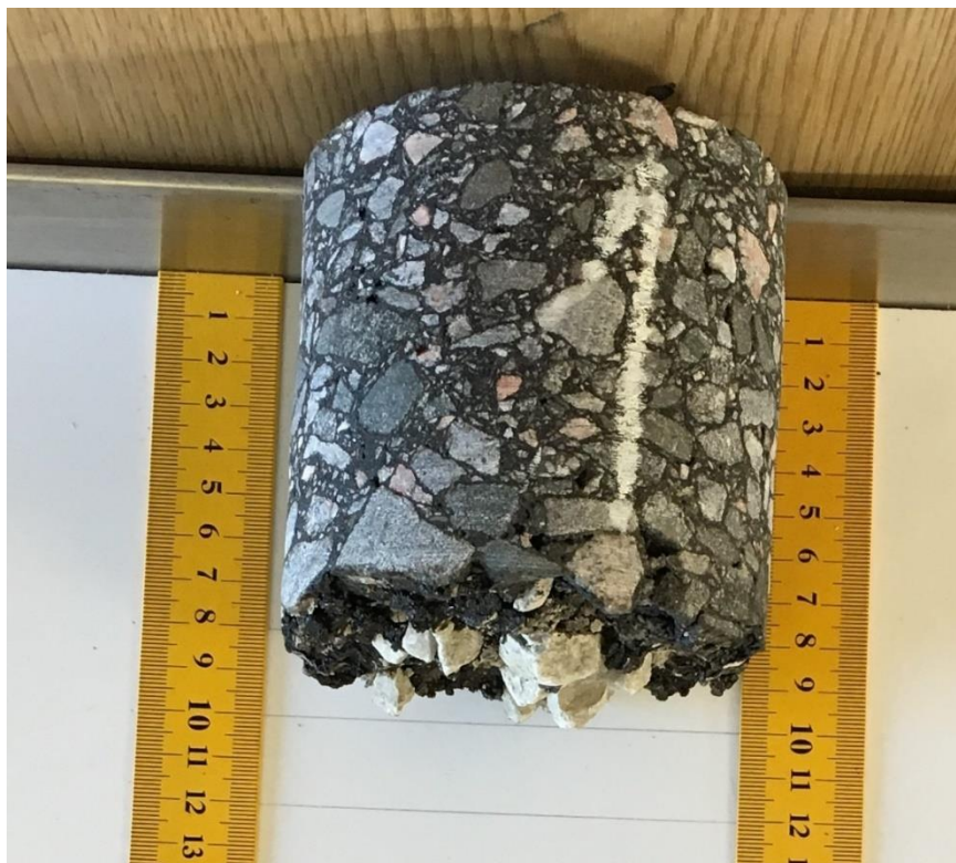
Joonis 2.10 Objekti D puurkeha nr 1. Surf ja base kattekihi vaheline joon on vaevumärgatav
