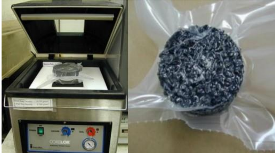
Joonis 3.6 Vasakul Corelok seade, paremal kile ja vaakumiga suletud katsekehaga [14]
