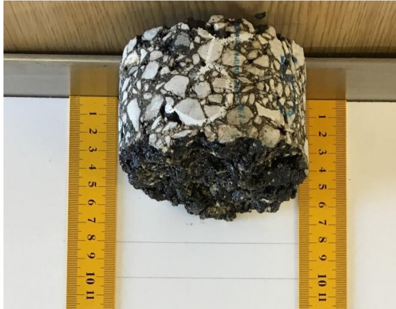
Joonis 2.6 Objekti B puurkeha nr 5, mille mõõtmistulemused varieerusid 55-66 mm.
