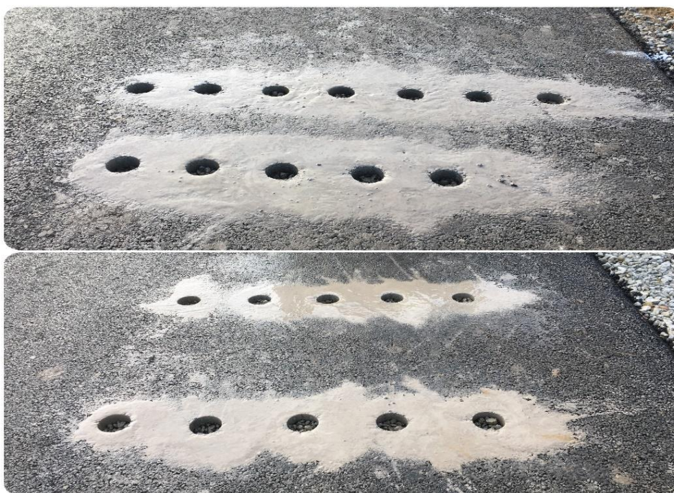
Joonis 2.5 Objekti B puurkehade võtmise skeem. Ülemisel pildil esimene seeria
