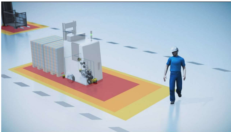
Joonis 2.14. Ohutuslaserite ohutusväljad. (SICK koduleht 01.01.2020 )
