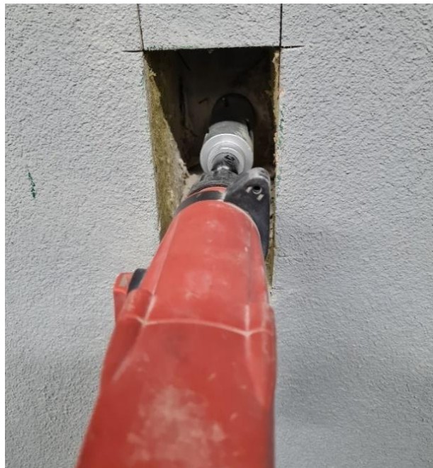
Joonis 19 Katsekehade lõikamine peale külmatsükleid (vasakul). Müüritise katsekeha puurimine (paremal).
