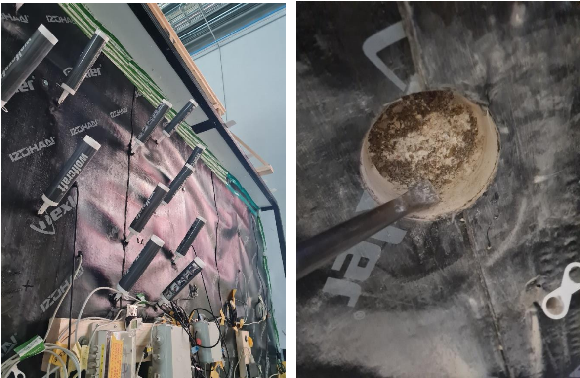
Joonis 16 Vee injekeerimine katseseina (vasakul). Niiskussisalduse kontrollimine peale vee injekeerimist (paremal).
