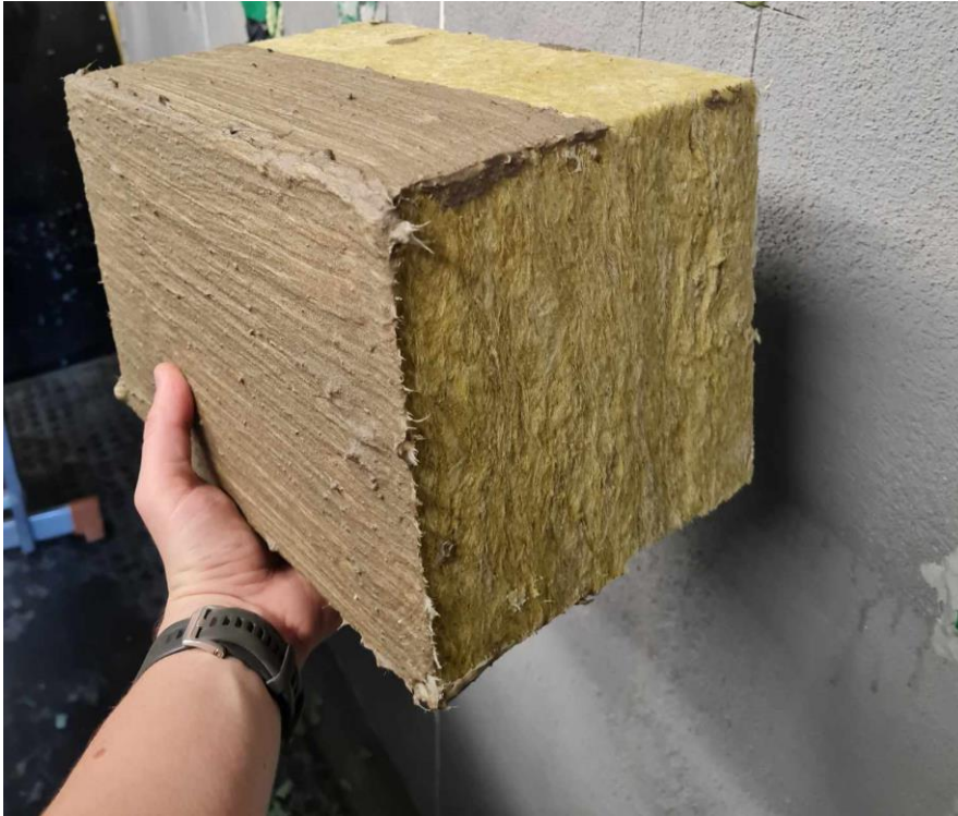
Joonis 37 Kolmelt küljelt hüdroisoleeritud villariba näidis
