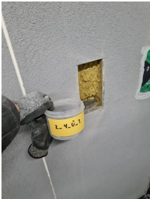
Joonis 19 Katsekehade lõikamine peale külmatsükleid (vasakul). Müüritise katsekeha puurimine (paremal).
