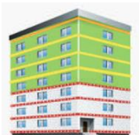
Joonis 2 Soojustuse paksus \leq 300 mm, krohvitud kattekihtidega EPS tuletõkkevööd (3)
