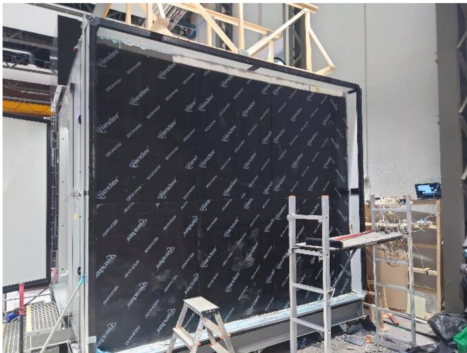
Joonis 10. SBS rullmaterjal katsehalli (ehk sisekeskkonna) poolsel pinnal
