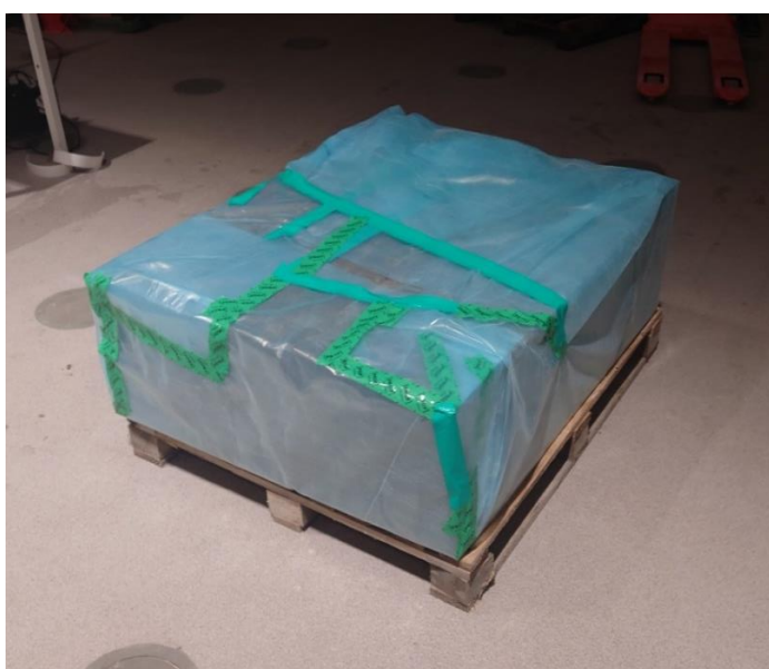
Joonis 5. Killesse pakitud välistingimustes seisnud müürikivid
