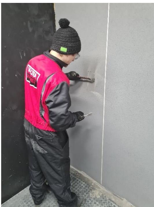
Joonis 17 Krohvitüki eemaldamine katseseinast (vasakul). Katsekeha minigrip kotis (paremal).
