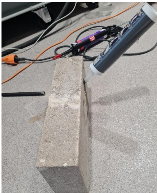
Joonis 15 Vee injekeerimise katse üksiku müürikiviga
