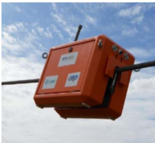
Joonis 1.14. Korrosioon avastamise robot [2]
