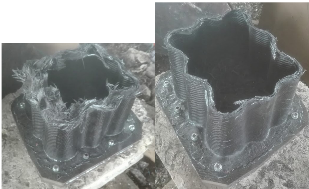
Sele 11.6 12-kihiline katsekeha (vasakul) ja 10-kihiline katsekeha (paremal) pärast kokkupõrkekatsetust
