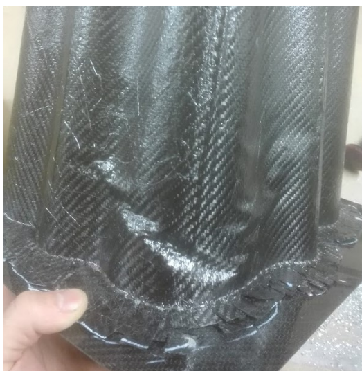
Sele 11.4 Ahjutsükli käigus tekkinud tootmisviga
