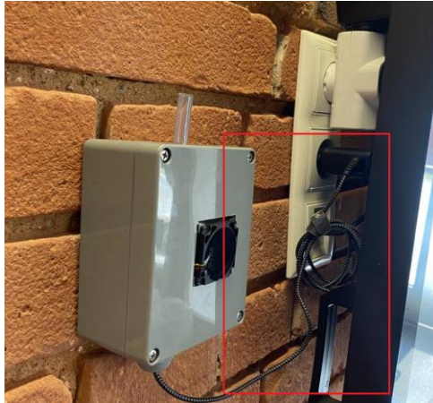
Joonis 6.1 Adapter ühendatud teleka taga olevasse pistikupesasse, sealt edasi Micro-B kaabel. USB ots on ühendatud adapteriga ja Micro-B ots kontrolleriiga.
