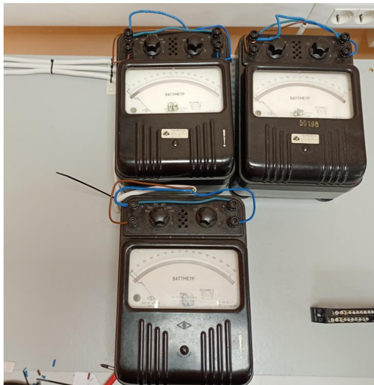
Joonis 2.16 Vattmeetrite ühendamine
