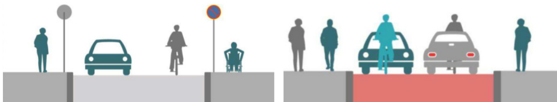
Joonis 3.14 – Segaliiklusega tänava ja jalgrattatänav põhimõttelised skeemid. [12]
