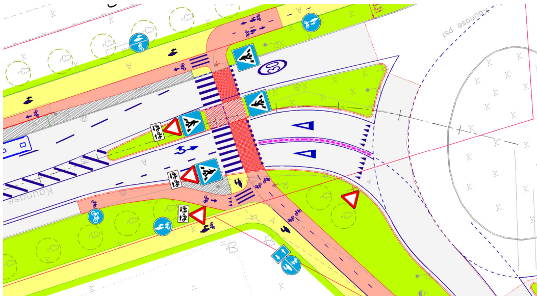
Joonis 2.7 Ülemineku lahendusega Kaunase pst harule III kavandatud geometria (autori joonis).
