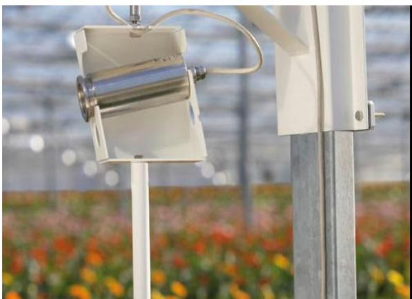
*Рисунок 9 Оригинальный датчик температуры и влажности Hortimax [31]*
