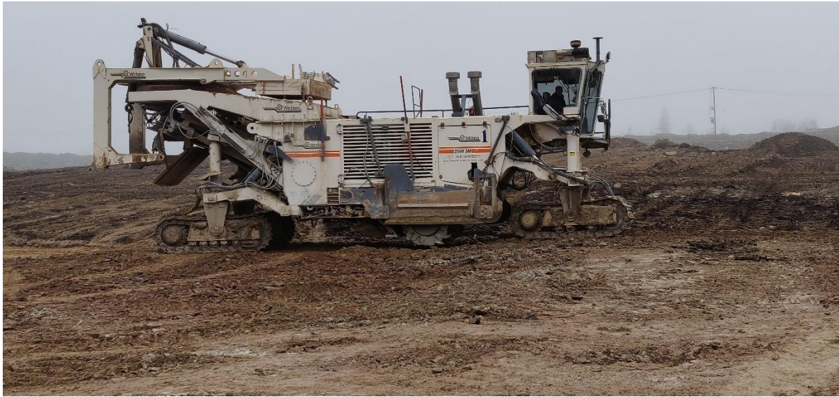
Joonis 7. Põhja-Kiviõli II põlevkivikarjääris töötav mäekombain Wirtgen 2500 SM. Põlevkivi referentsproove koguti samast kohast.
