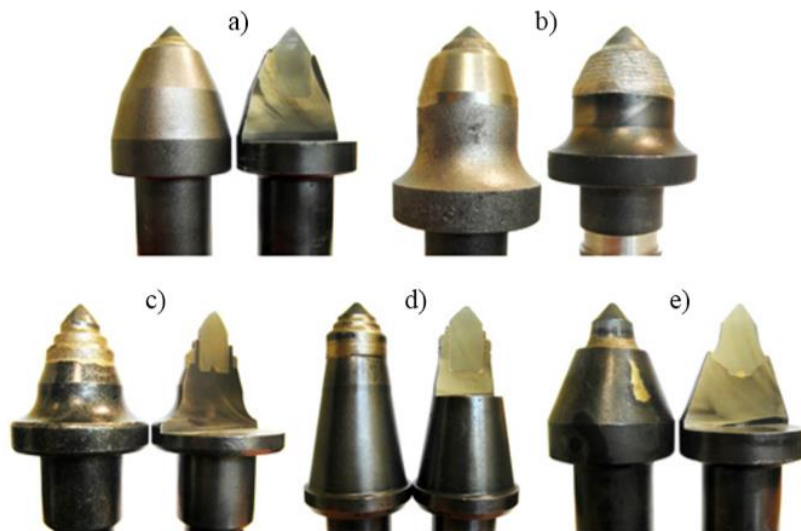
Joonis 19. Erinevad viisid lõikehamba kaitsmiseks karbiidiga, a) standardne lõikehammas, b) keevitatud lõikehambad, c) lõikehammas paagutatud karbiidist rõngaga, d) lõikehammas rõngaga, e) alandatud kehaga paagutatud karbiidist CAP-tüüpi lõikehammas. [25]
