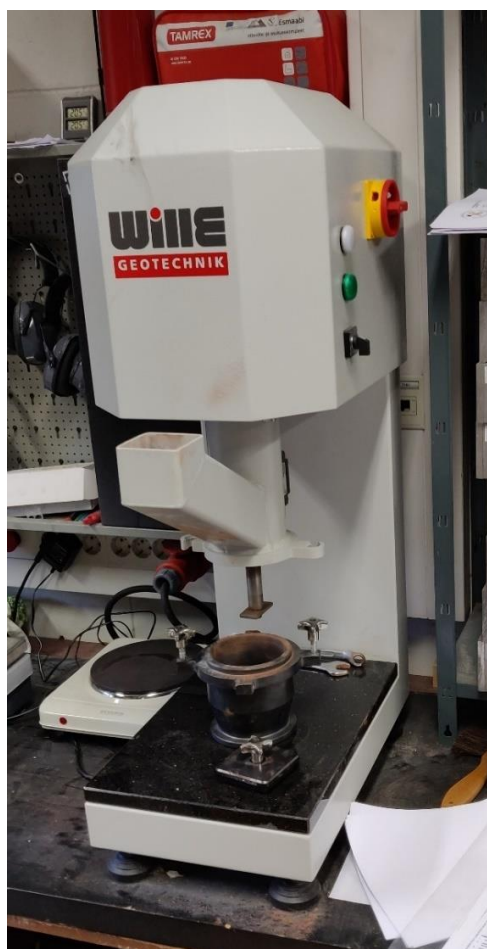
Joonis 8. Wille Geotechnik abrasiivsuse määramise seade AT 1.
