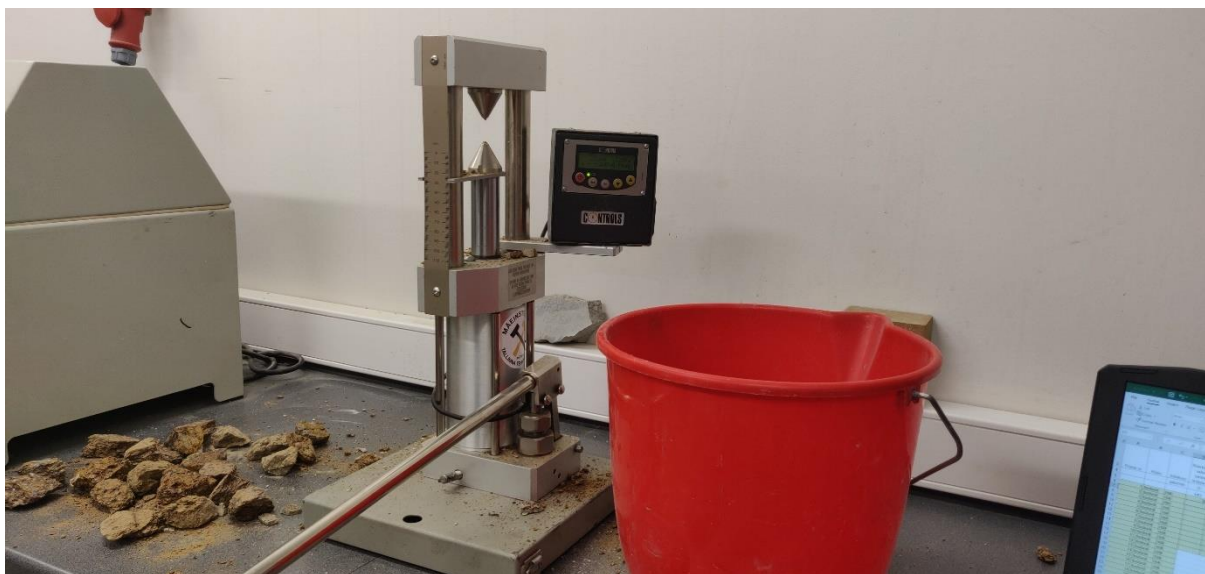
Joonis 12. PKT masin koos purustatud fosforiidiga.
