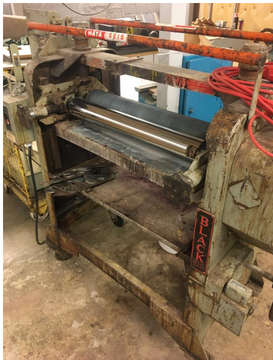
Sele 4.1. Laboris kasutusel olev liimitusseade (valtsid)
