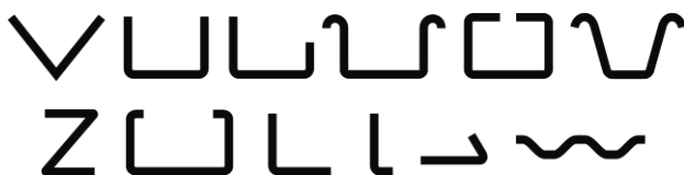
Joonis 8.14. Külmmaltsprofileerimise teel leht- või ribatoorikust toodetud paindprofiilid
