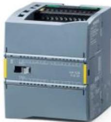
Рисунок 3.23 отказоустойчивый модуль дигитальных входов [12].
