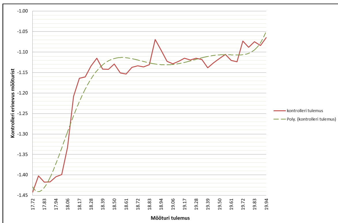
Joonis 5.2. Ruumi A102 ruumikontrolleri mõõtemooduli ja HOBO mõõturi mõõdiste erinevus mõõtemooduli erinevate temperatuurimõõdiste korral
