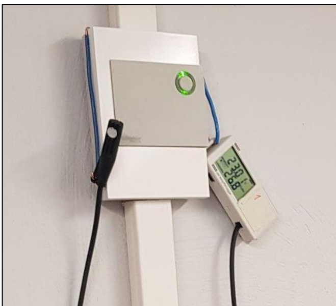
Joonis 5.1. Mõõtemoodulil ja HOBO mõõturi asetus temperatuuri mõõtmise ajal
