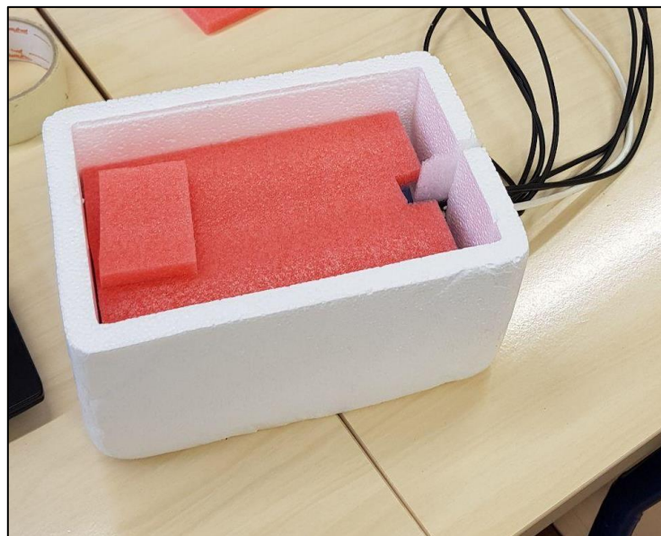
Joonis 4.1. HOBO mõõturite sensori paigutus termokastis katsete tegemiseks
