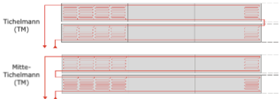
Joonis 1.12 Tichelmanni ja mitte-Tichelmanni tüüpi päikesekollektori paigutus [30]
