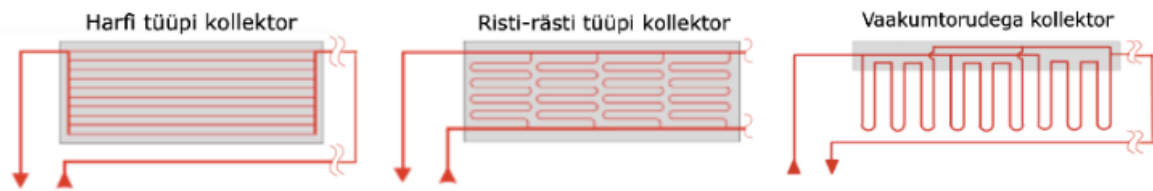
Joonis 1.11 Erinevate absorbertorustike konfiguratsioonidega kollektorite tüübid [30]
