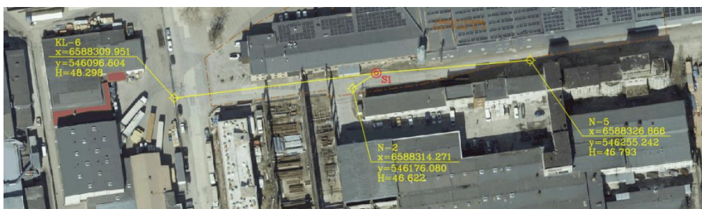
Joonis 11. Test 2 joonelis-nurgalise vastulõike skeem (tahhümeetri seisupunkt on punaselt).
