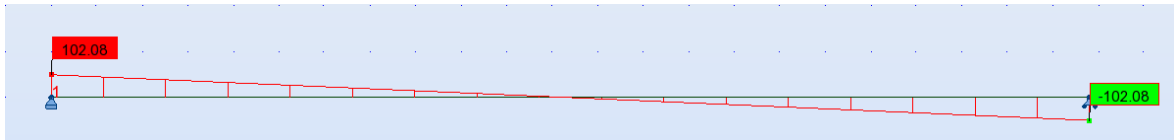
Joonis 3.1. Tala T-1-1 paindemomendi ja põikjõu epüürid kandepiirsesundis.
