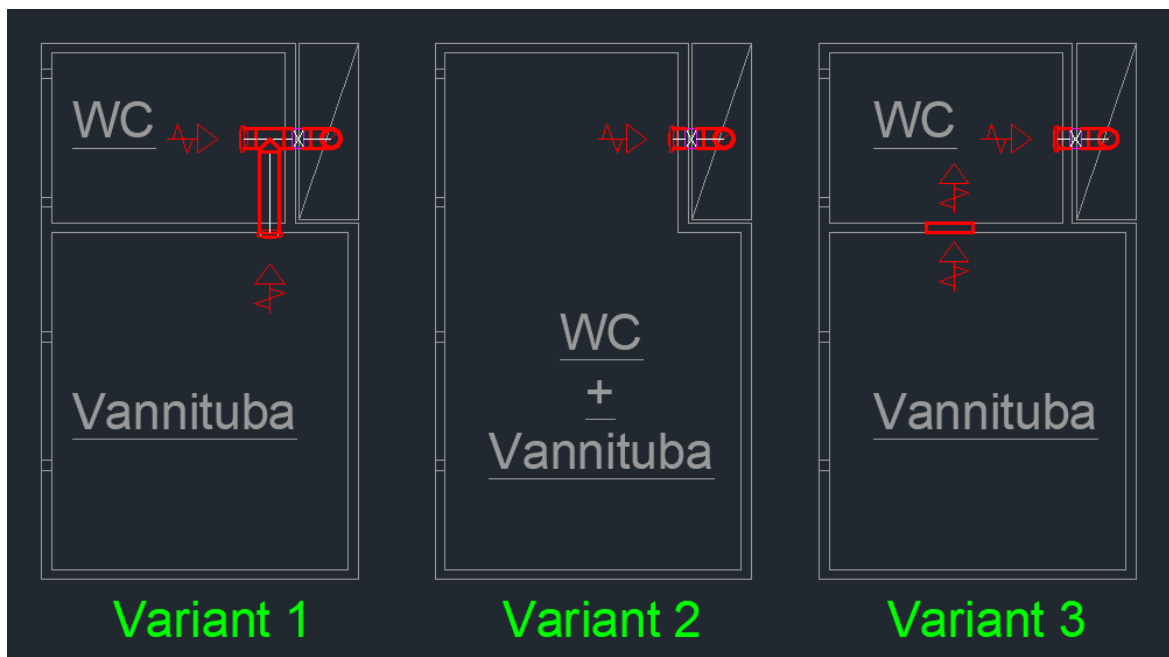
Joonis 3.14 Sanitaarsõlmede ruumide väljatõmbe lahenduse variandid.
