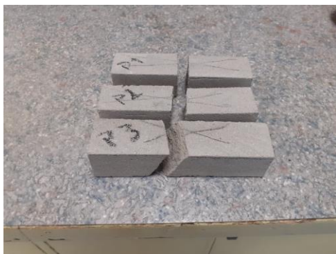
Joonis 3.17 Purustatud paindekatskehad niiskuse määramiseks
