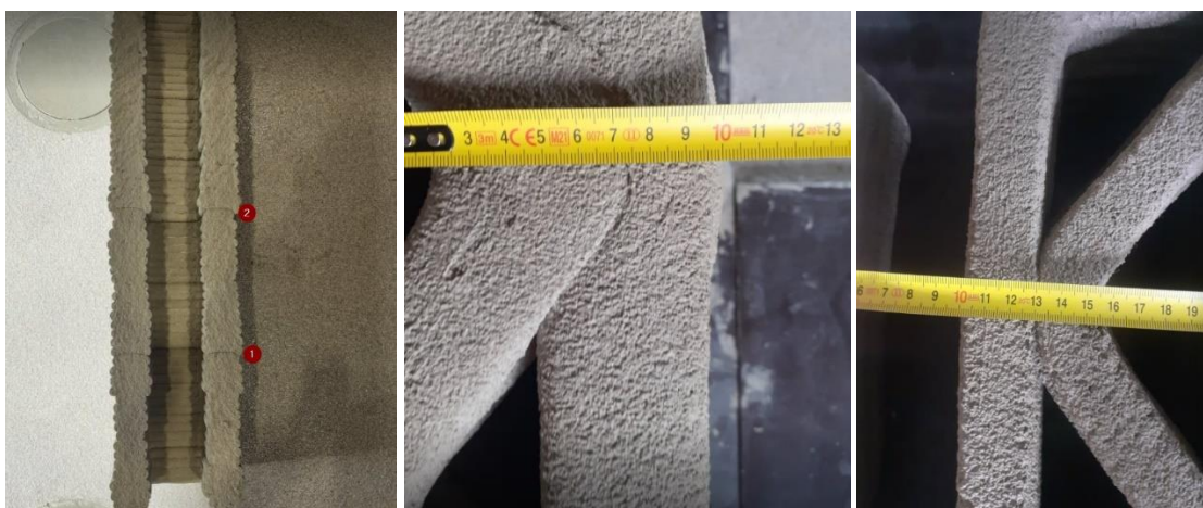
Joonis 3.8 Katsekehade geomeetrilised ebatäpsused. Prinditud ristlõike geometria ja erinevatel päevadel prinditud betooni mõju nakketugevusele (vasak), prinditud kihi laiuse mõju ristlõike seotusele (paremal).
