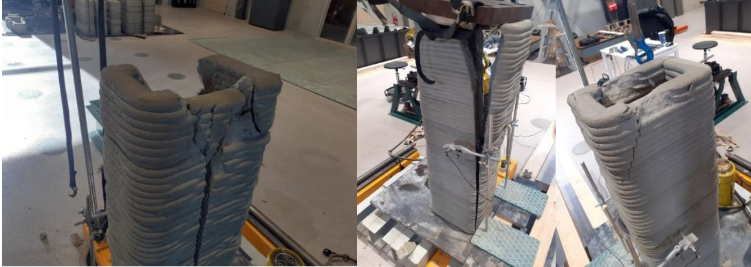
Joonis 3.4 Postide purunemispildid – kiilu teke koos lõhestumispurunemisega (vasakul), ühepoolne muljumine koos lõhestumispurunemisega (keskel), nurga murdumine ühepoolsest muljumisest (paremal)
