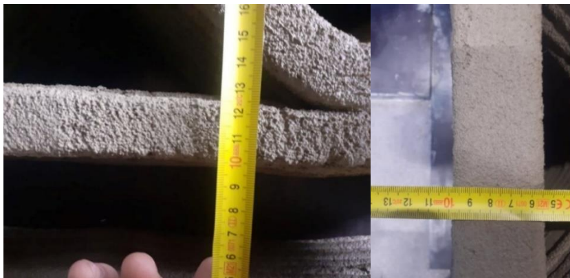
Joonis 2.3 Printimisegu vanuse mõju prinditud kihi laiusele
