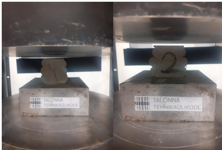
Joonis 3.12 Ribidega kuupide purunemispildid suund I sihis
