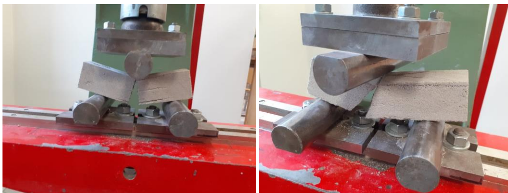
Joonis 3.16 Purunemispildid katsekeha P1 (vasakul) ja katsekeha P3 (paremal)
