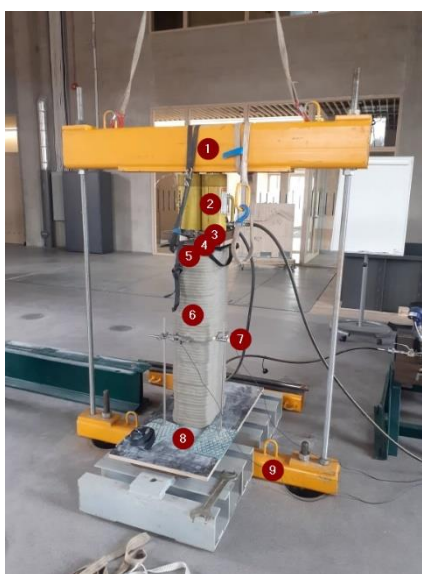
Joonis 2.5 Katseskeem posti ja seinte koormuskatsetel
