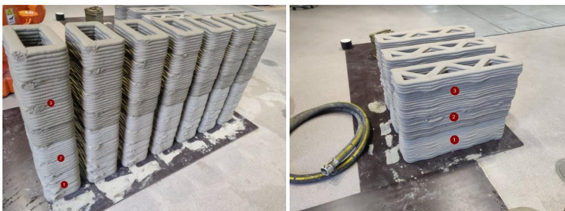
Joonis 2.2 3D prinditud katsekehad – postid (vasakul) ja seinaelemendid (paremal) etappide kaupa
