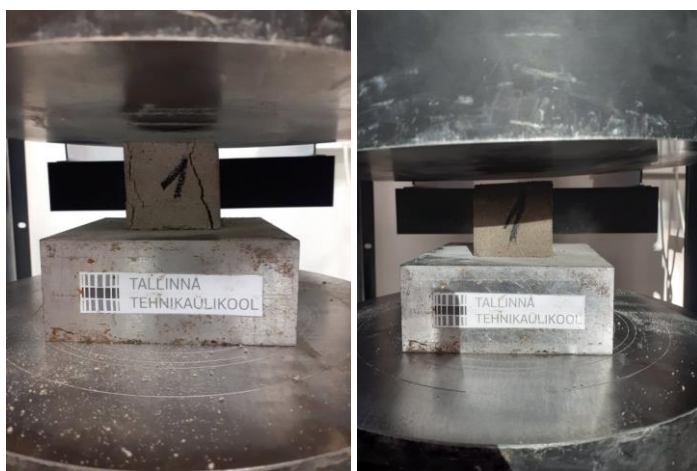
Joonis 3.14 Kuivades ja märgades tingimustes purustatud kuupide purunemispildid
