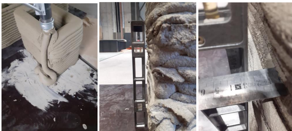
Joonis 2.4 Printimise tehnoloogiast tekkinud ebatäpsused ja vead katsekehade geometrias
