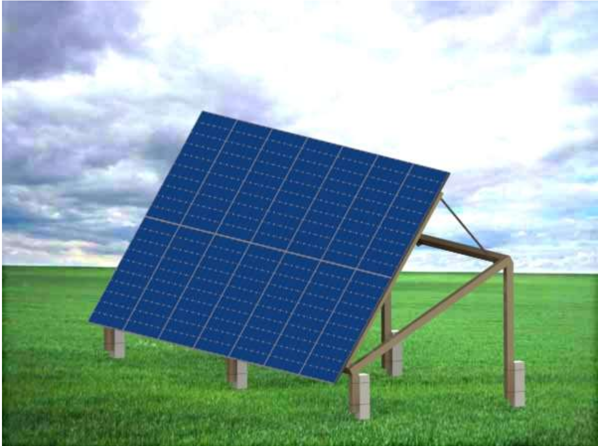
Joonis 4.2. Päikesepaneelide kinnituse kujutav joonis 57° kalde puhul
