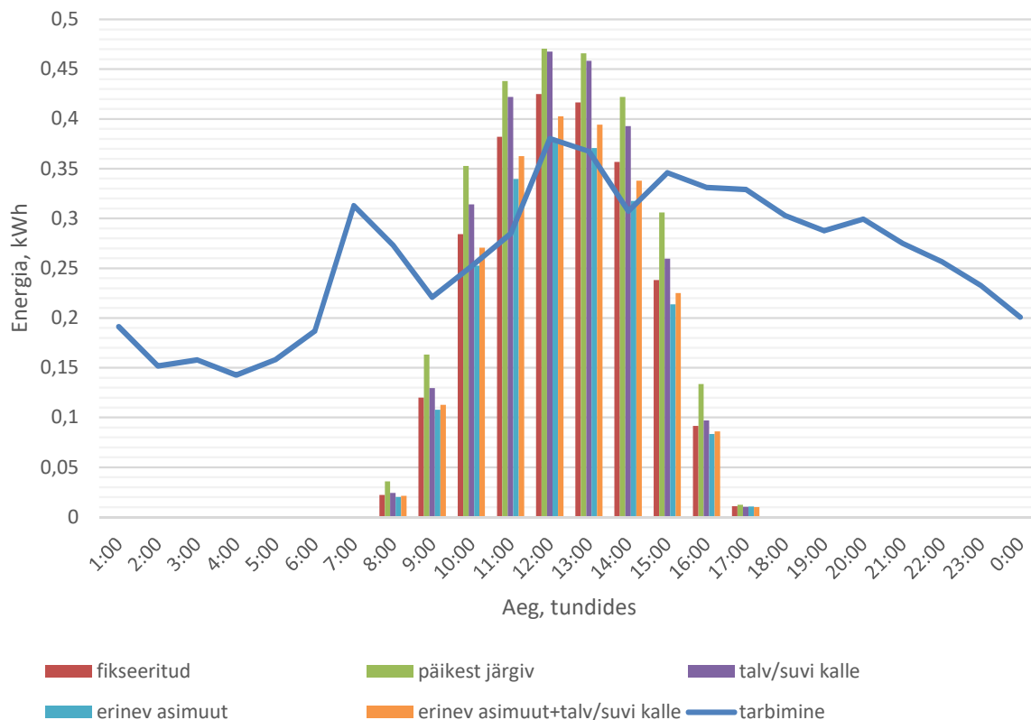
Joonis 3.20. Talve keskmine ööpäevane tarbimine ja valitud süsteemi toodang
