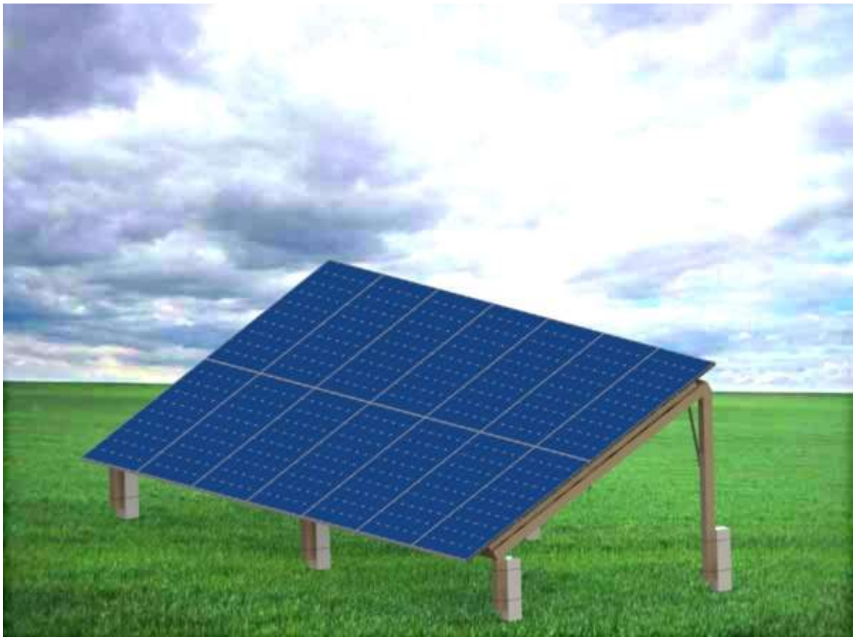
Joonis 4.1. Päikesepaneelide kinnituse kujutav joonis 29° kalde puhul
