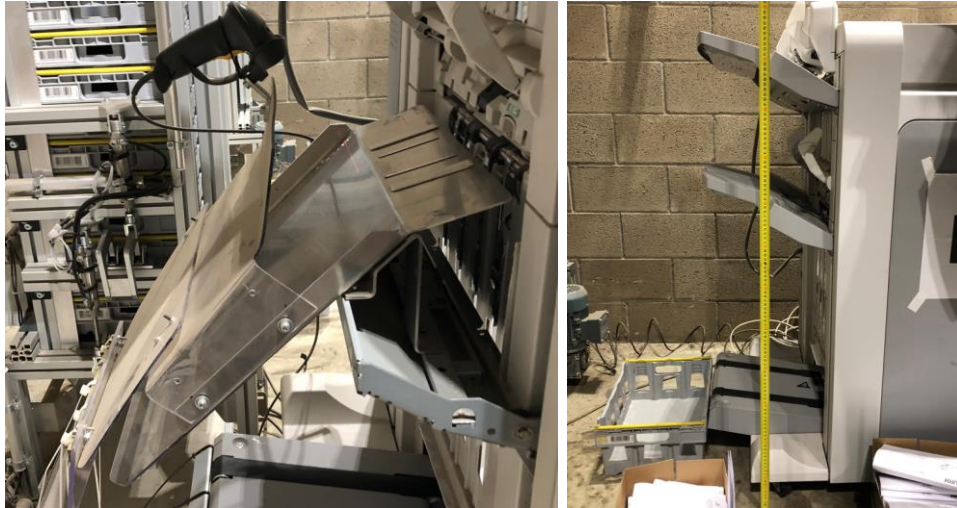
Sele 5.15 Printeri väljastussahtli asendus lehtede suunajaga vasakul ja originaal paremal
