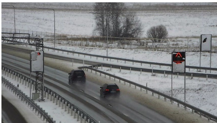
Joonis 4.1 Muutuva teabega kiirus- ja hoiatusmärkide seisukord pärast lumetuisku [4]
