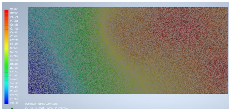
Joonis 9.5 Kuivajõe VMS-i esipaneeli temperatuuri modelleerimise tulemused ilma lumeta
