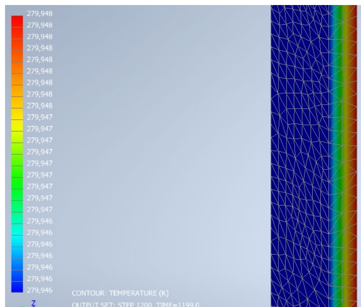
Joonis 9.2 Kasti VMS-i esipaneeli temperatuuri modelleerimise tulemused ilma lumeta
