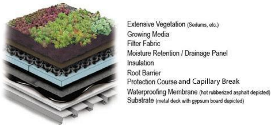
Joonis 1 Ekstensiivse katusehaljastuse aluskonstruktsioon (allikas: greenhome) (55)
