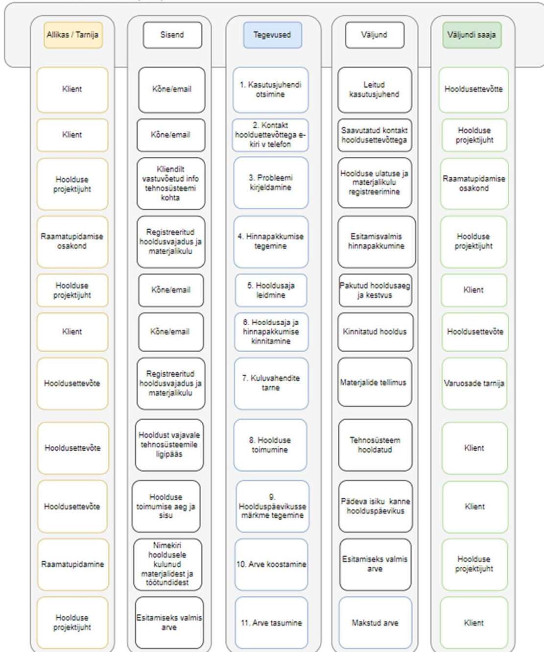
Joonis 17 Tehnosüsteemide hooldus SIPOC diagramm (AS-IS) (autori koostatud)
