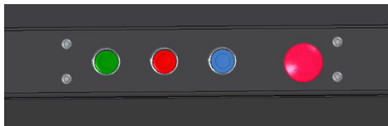
Joonis 4.7. Erinevate nuppude asetus kvaliteedikänneri peal. Vasakult paremale: Start, Stop, Reset , Hädastopp.
