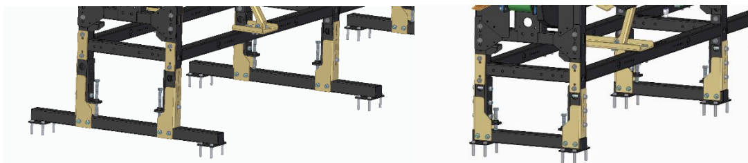
Joonis 1.4. Sorteerimisliini raami vanad (vasakul) ja uued (paremal) jalad.
