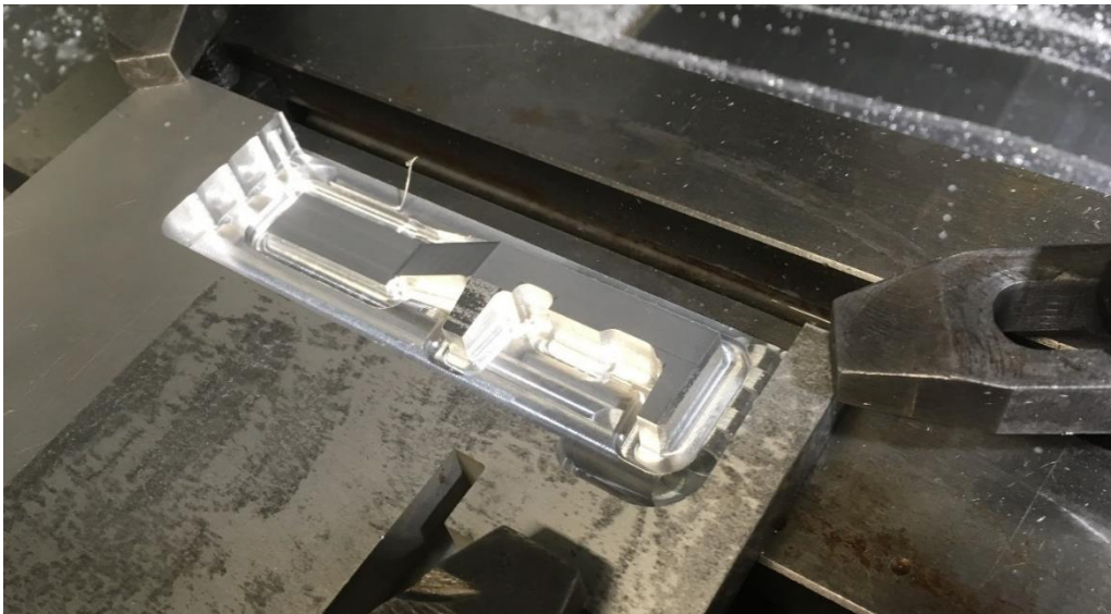
Joonis L9.2 Autori detaili CNC freesprotsess
