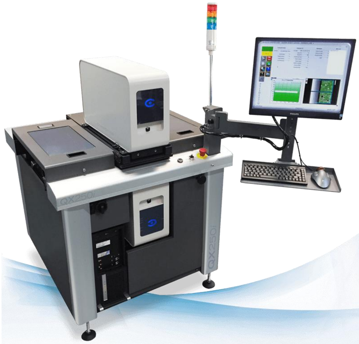
Joonis L3.1 Automaatse optilise inspeksiooni seade [63]
