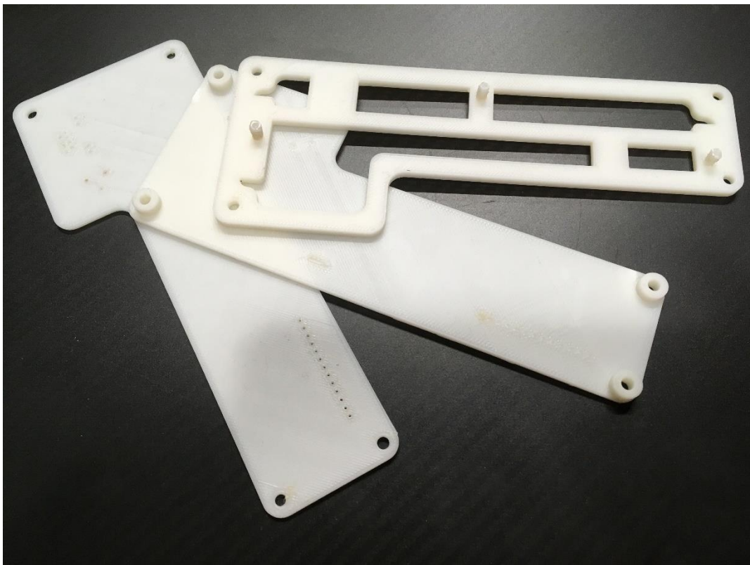
Joonis L8.2 Armatuuri 3D prinditud kihid
