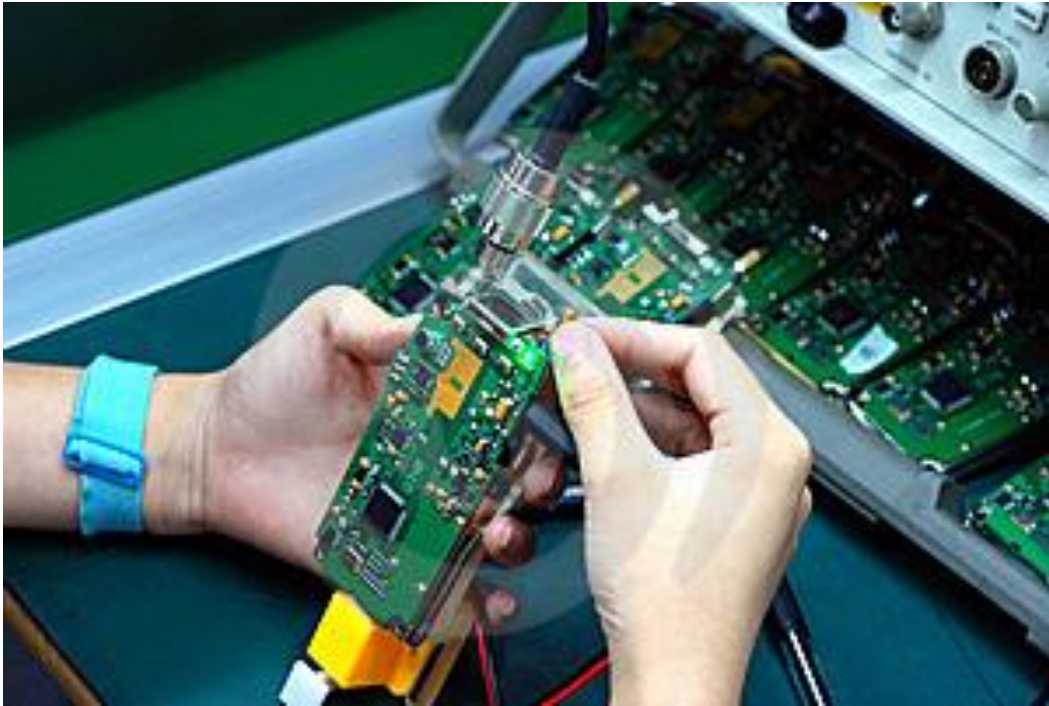
Joonis L5.1 Funktsionaaltestimises elektroonikakoost [65]
