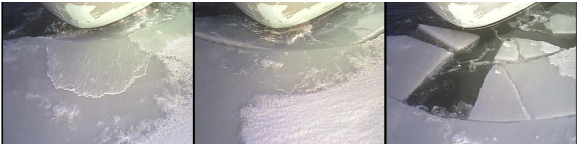
Joonis 3.1 Jää purustamine KV Svalbard vööri poolt (3. fotol on antud tagasikäik), (Lubbad & Løset, 2011)
