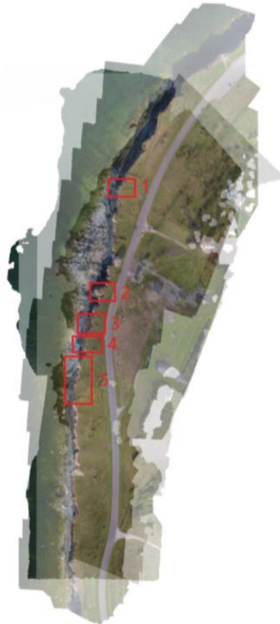
Joonis 3. Artur Karjalaineni poolt koostatud kolme aasta joondatud ortofotoplaanid. Plaanil on välja toodud viis ala, kus toimus erosioon
