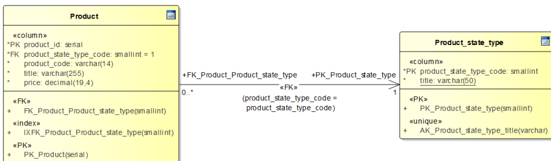
Joonis 9. Tabeleid toode ja toote seisundi liik kujutatav klassidiagramm.
