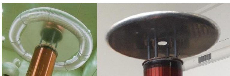
Joonis 2.3 Marco Denicolai poolt paigaldatud vana toroid (vasakul) ja Energia avastuskeskuses paigaldatud uus toroid [16]
