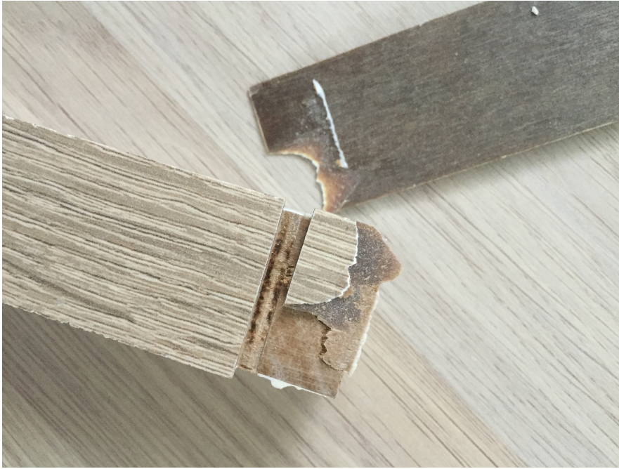
Joonis 12. Purunenud katsekeha HPL ja PVA liimiga
