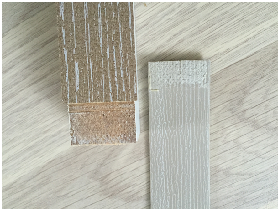
Joonis 15. Purunenud katsekeha ABS ja kuumsulamliimiga
