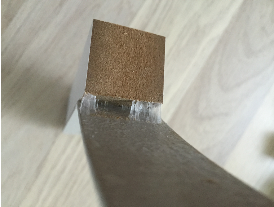
Joonis 16. Purunenud katsekeha ABS ja STA-PUT liimiga
