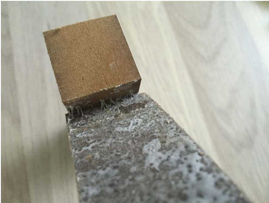
Joonis 14. Purunenud katsekeha HPL ja STA-PUT liimiga
