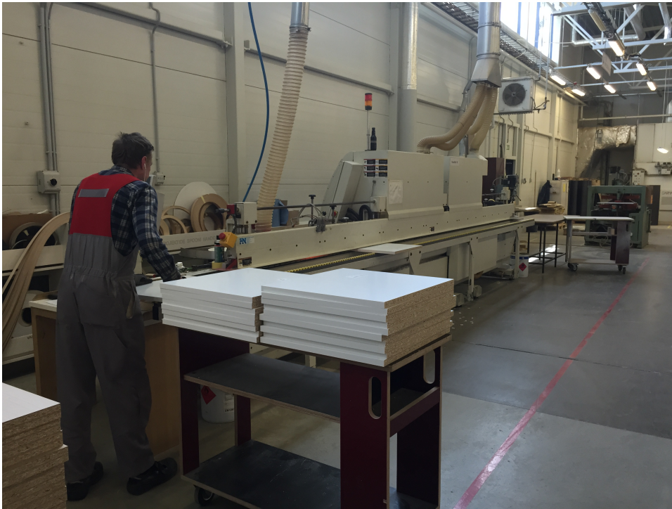
Joonis 2. Servapealistusliin IMA Advantage Expert 6216-2/L12 Sarkopis
