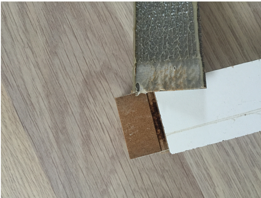
Joonis 13. Purunenud katsekeha HPL ja kuumsulamliimiga
