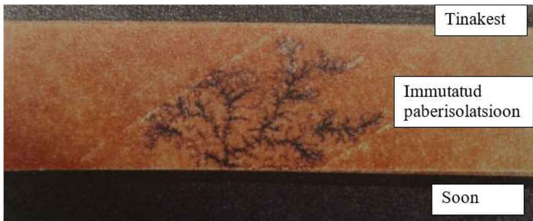
Joonis 1.4 Dendriidid immutatud paberöliisolatsioonis [5]
