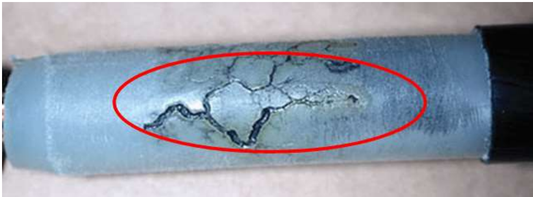
Joonis 1.3 Dendriidid XLPE isolatsiooniga keskpingekaablis [8]
