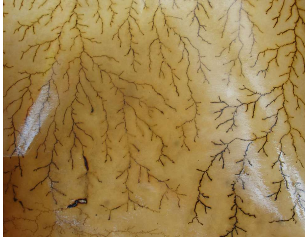
Joonis 1.5 Dendriidid 30 kV kõrgepinge kaablimuhvi isolatsioonis [9]
