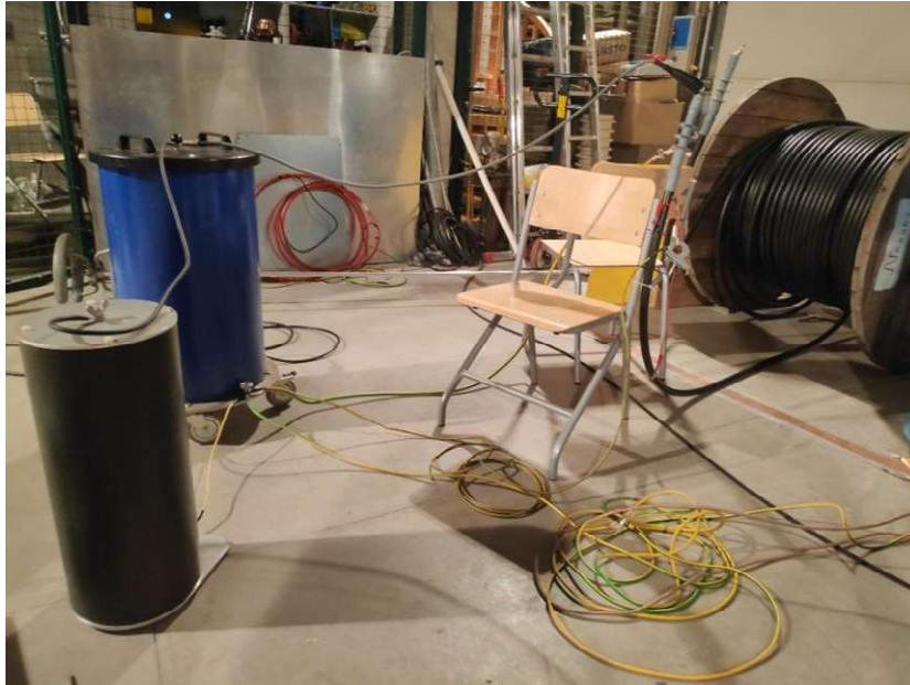
Joonis 3.5 OWTS mõõteseadme Taltech kõrgepingelaboris katsete teostamise ajal
